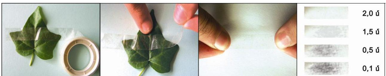
Նկ. 146. Օղի՝ փոշով աղտոտվածության գնահատման փորձի ընթացքը
